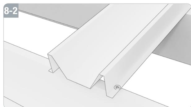
Legen Sie die Schienen mit M-Profil (S) in gleichmäßigem Abstand von 1154 mm parallel zu den Dachträgern (C). Verschrauben Sie zuerst die Enden der Schienen mit M-Profil (S) an der Regenrinne (N) mit den M6,3 x 25 selbstschneidende Schrauben (O).
