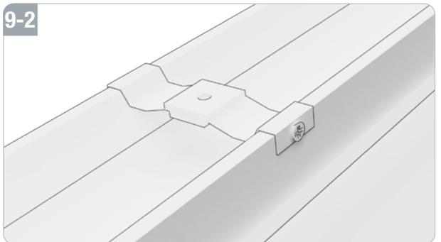
Danach schrauben Sie die mitgelieferten Klammern mit den M6,3 x 25 selbstschneidende Schrauben (O) auf die Schienen mit M-Profil (S). Auf einer Schiene mit M-Profil (S) werden sechs Klammern befestigt.
