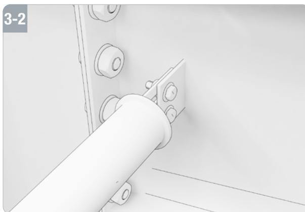
Befestigen Sie die Distanzstreben (E) an den Dachträgern (C) mit den gelieferten M12 x 35 Sechskantschrauben (F), Muttern und Unterlegscheiben
