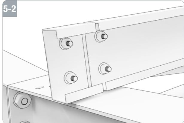
Befestigen Sie die Schiene mit C-Profil (J) an die zwei inneren Löcher des bereits montierten Winkels der Dachträger (C). An den beiden äußeren Löchern des Winkels verschrauben Sie die Verbindungsstücke mit C-Profil (K) und ziehen diese fest an. Nutzen Sie hierfür die mitgelieferten M12 x 35 Sechskantschrauben (F) inkl. Muttern und Unterlegscheiben.
