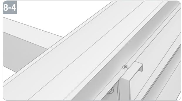
Anschließend nutzen Sie weiterhin die M6,3 x 25 selbstschneidende Schrauben (O), um die Schienen mit M-Profil (S) an die Schienen mit C-Profil (J) zu montieren.
