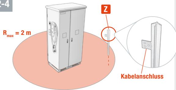
Schlagen Sie den Erdspieß (Z) in einem maximalen Abstand von 2 m von dem Schaltkasten entfernt in die Erde. Befestigen Sie das Kabel an dem oberen Ende.
