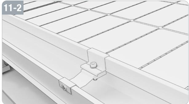
Befestigen Sie die Solarmodule mit Hilfe der äußeren Klemmen (V) an den beiden außenliegenden Schienen mit M-Profil (S).
