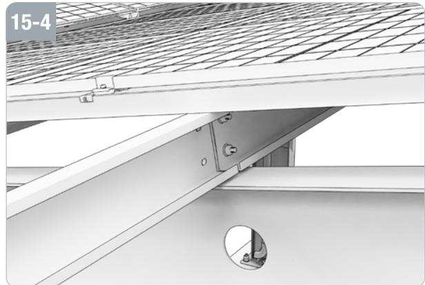
Befestigen Sie die Schienen mit C-Profil (J) des Anbaufeldes an den Winkeln der Dachträger (C) der aufgebauten Parkplatzüberdachung.
