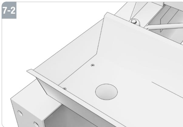
Befestigen Sie die Regenrinne (N) mit den vier M6,3 x 25 selbstschneidende Schrauben (O) an den beiden Stützpfosten (A).
