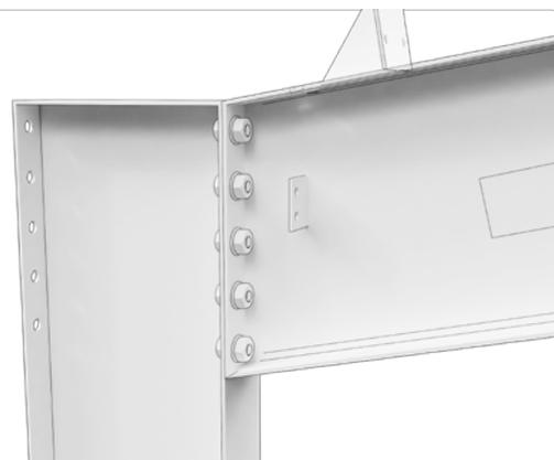
Montieren Sie den Dachträger (C) mit den M20 x 40 Sechskantschrauben (D) inkl. Muttern und Unterlegscheiben auf dem Stützpfosten (A).
