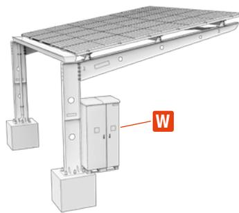
Positionieren Sie den Schaltschrank (W) an einen der äußeren Stützen (A).
