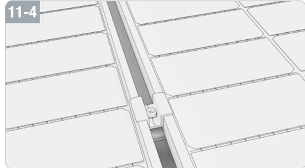
Mit den mittleren Klemmen (U) werden die Solarmodule innerhalb der Überdachung auf die Schienen mit M-Profil (S) montiert. Ein Solarmodul wird rechts und links jeweils mit zwei Klemmen fixiert. Die Stecker der Solarmodule sind MC4 kompatibel.
