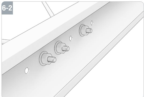
Stecken Sie die Diagonalstrebe (L) und Längsstrebe (M) durch die vorgesehenen Löcher der Schiene mit C-Profil (J). Ziehen Sie die Diagonalstreben (L) und Längsstreben (M) mit den beiliegenden Muttern und Unterlegscheiben an.
