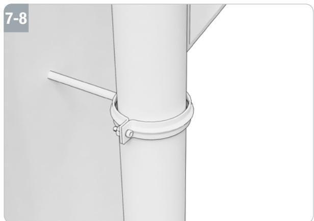
Mit den beiden mitgelieferten Schellen (R) inkl. Schrauben können Sie das Fallrohr (P) an den Stützposten (A) verschrauben.
