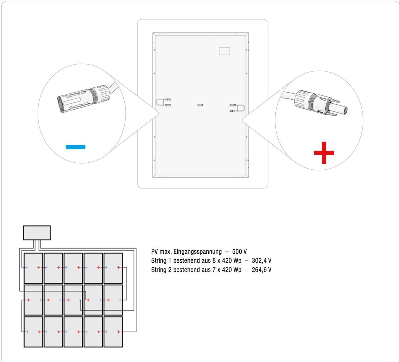
Achten Sie darauf, dass die Solarmodule, als 2 Reihenschaltungen angeschlossen werden müssen.
