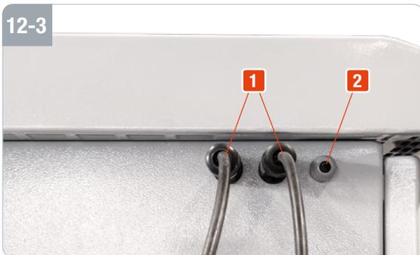
Stecken Sie die Kabel der Solarmodule und das Stromkabel der Leuchte nach komplett abgeschlossener Montage ein. Die Kabel der Solarmodule in 1 und das Kabel der Leuchte in die Öffnung 2.
