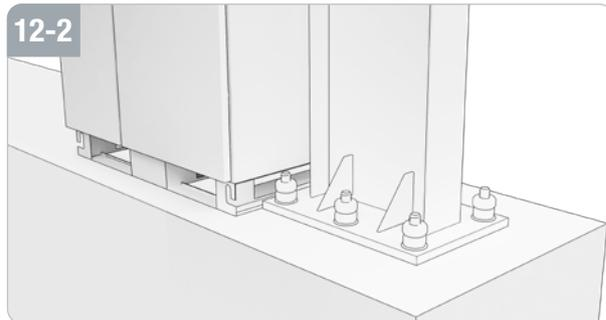
Der Schaltschrank sollte so nah wie möglich an dem Standfuß positioniert werden.
