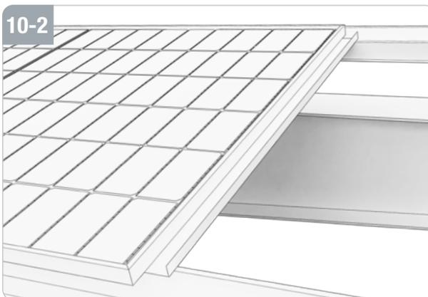
Legen Sie die Schiene mit U-Profil (T) quer zwischen die Schiene mit M-Profil (S). Platzieren Sie zwei Schienen mit U-Profil (T) ober- und unterhalb des mittleren Solarmoduls pro 3er-Reihe.
