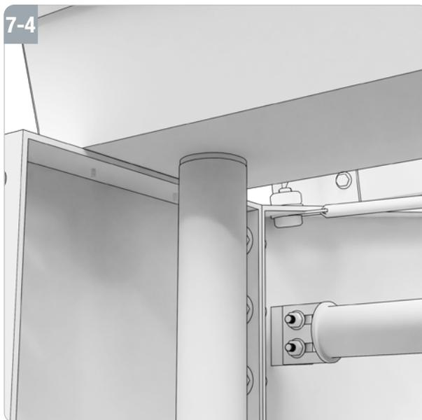
Stecken Sie anschließend das Fallrohr (P) in das vorgesehene Loch der Regenrinne (N).
