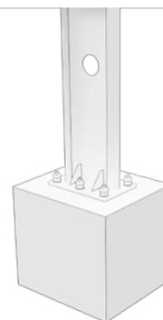
Gießen Sie ein weiteres Zementfundament, welches für die Parkplatzüberdachung ausreichend dimensioniert ist. Achten Sie hier auf die ideale Betonmischung und Fundamenttiefe. Befestigen Sie den Stützpfosten (A) in dem Fundament. Nutzen Sie hierfür die beigelegten M28 x 900 Betonbolzenanker (B) und ziehen Sie diese mit den beiliegenden Muttern und Schrauben fest an.
