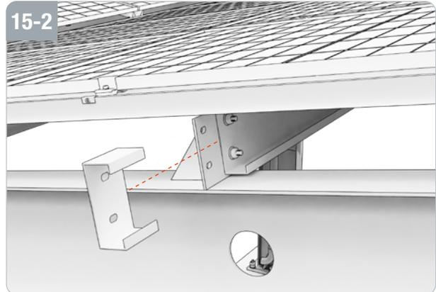
Entfernen Sie die Verbindungsstücke mit C-Profil (K) am Grundfeld.
