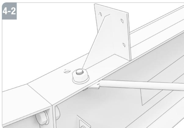
Stecken Sie die Diagonalstrebe (G) und die Diagonalstrebe (I) mit dem Diagonal-Spanner (H) zusammen. Montieren Sie die verbundenen Diagonalstreben (G) und (I) mit dem Diagonal-Spanner (H) überkreuzt an den Dachträgern (C). Verwenden Sie hierfür die beiliegenden M20 x 40 mm Sechskantschrauben, Muttern und Unterlegscheiben (D).
