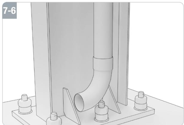
Auf das untere Ende des Fallrohrs (P) stecken Sie das Winkelstück (Q).
