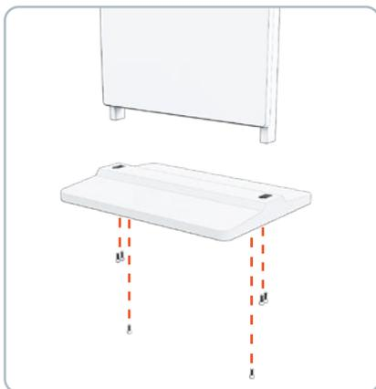
Fissare la base con le 6 viti in dotazione.
